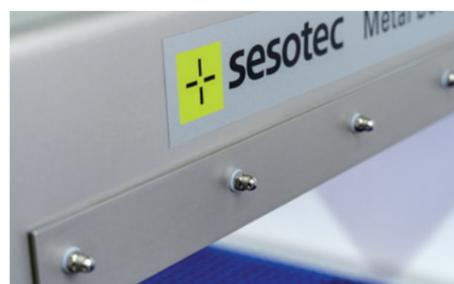
Hygienische Verschraubung: Jede Schraube ist hygienisch abgedichtet
