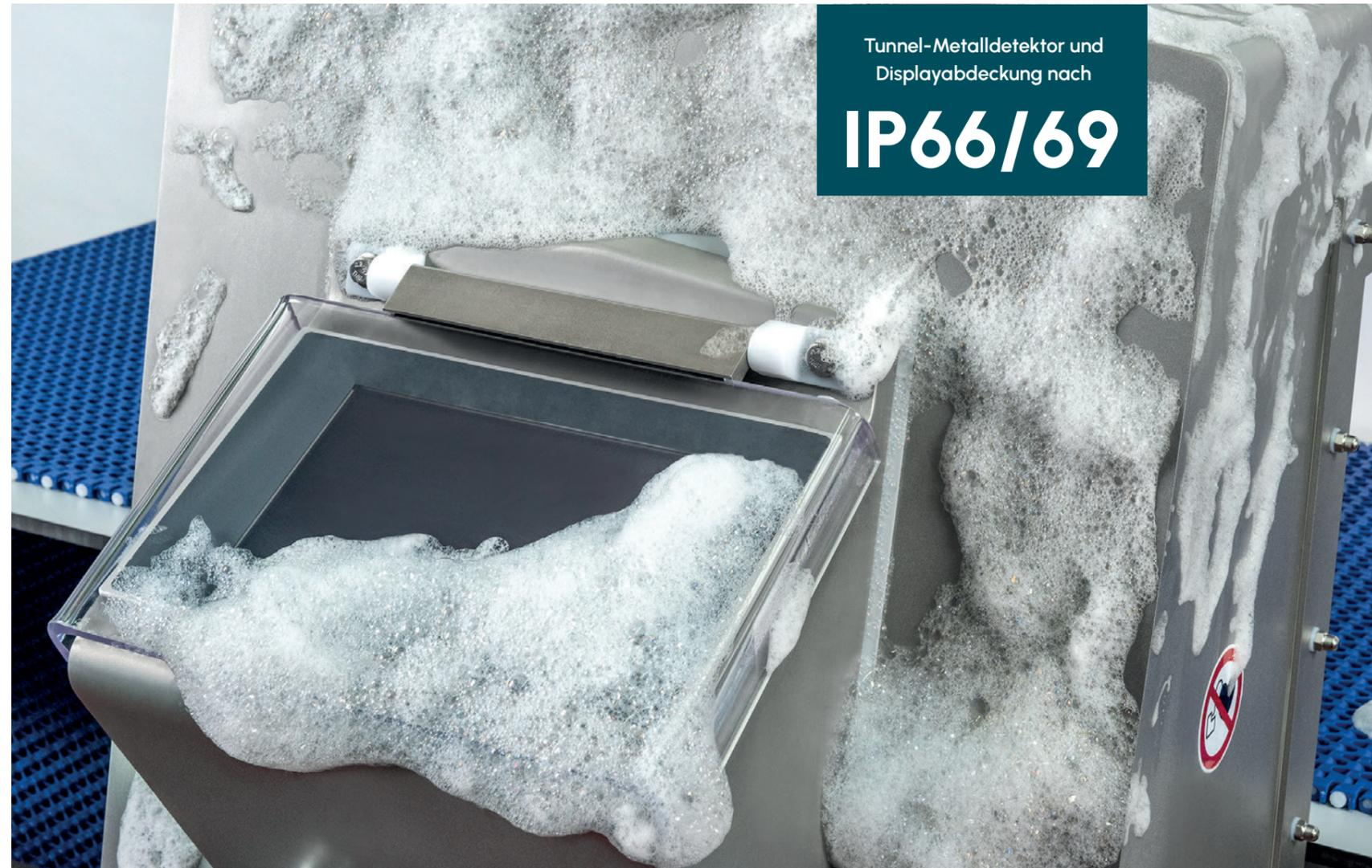
Tunnel-Metalldetektor und Displayabdeckung nach
