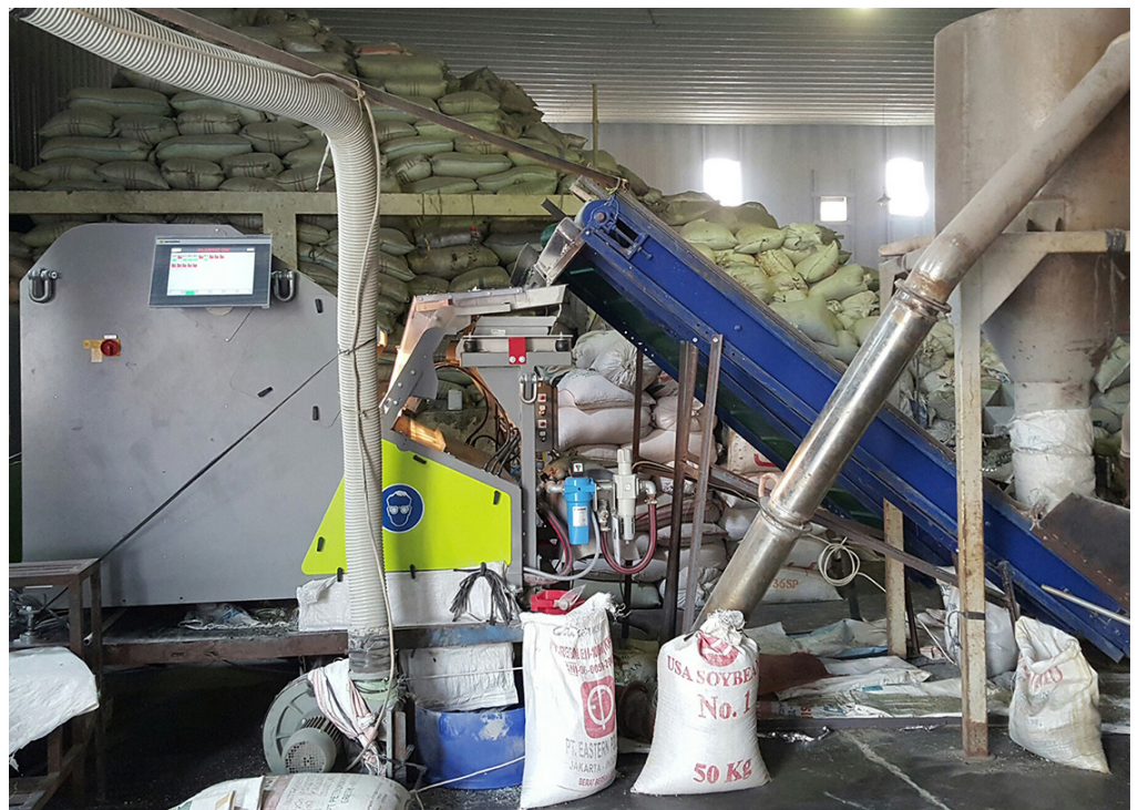
Bei PT. Rejeki Adigraha wird zur Kunststoffaufbereitung das Multi-Sortiersystem FLAKE PURIFIER von Sesotec (links im Bild) zur Separation von PVC eingesetzt.
