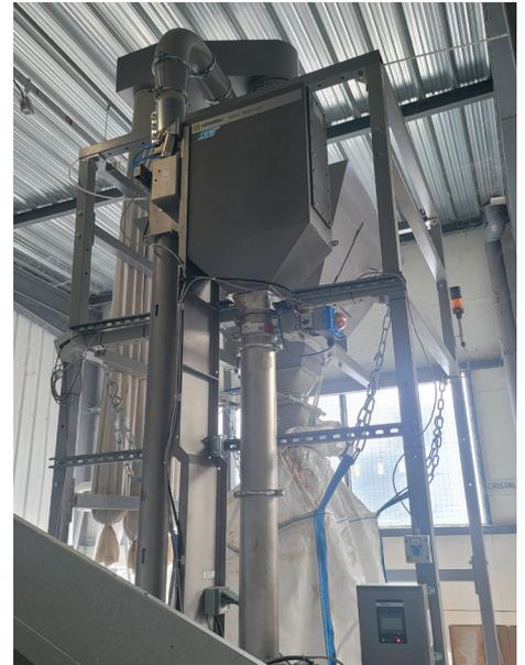
Nach dem Abzugsventilator wurde ein Sesotec Metall-Separator vom Typ GF in die Rohrleitung eingebaut, um auch kleinste Metallpartikeln zu separieren, bevor das Material in BigBags abgefüllt wird.
