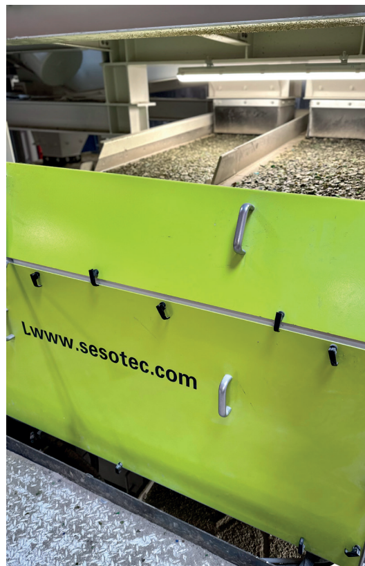
Reiling setzt zur Sortierung von dunklen Glasscherben Sesotec SPEKTRUM Glassortiersysteme mit speziellem C-C Sensor ein, um die Glasrückgewinnung deutlich zu verbessern (Foto: Reiling Gruppe)
