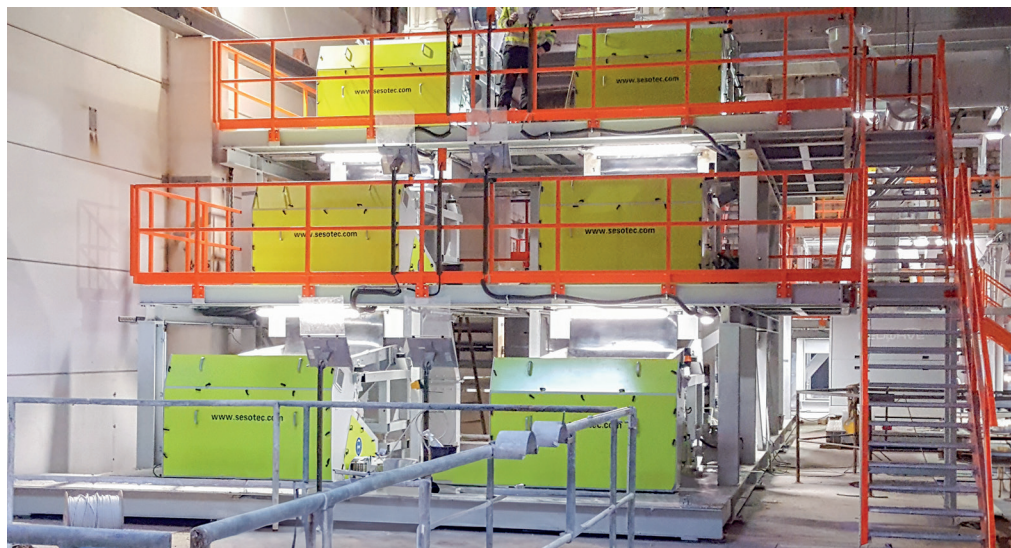
Am Reiling Recyclingstandort im dänischen Naestved werden zur Aufbereitung von Hohl- und Flachglas SPEKTRUM Glassortiersysteme von Sesotec eingesetzt (Foto: Reiling Gruppe)
