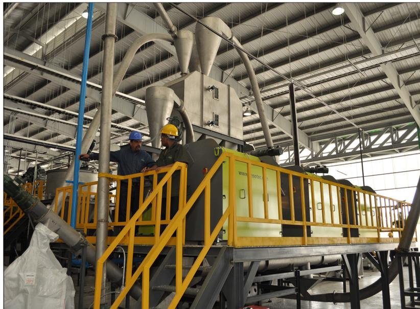
Bei GREEN Mind erfolgt die Feinsortierung der PET-Flakes mit Hilfe der Sesotec Sortiersysteme vom Typ FLAKE PURIFIER.
