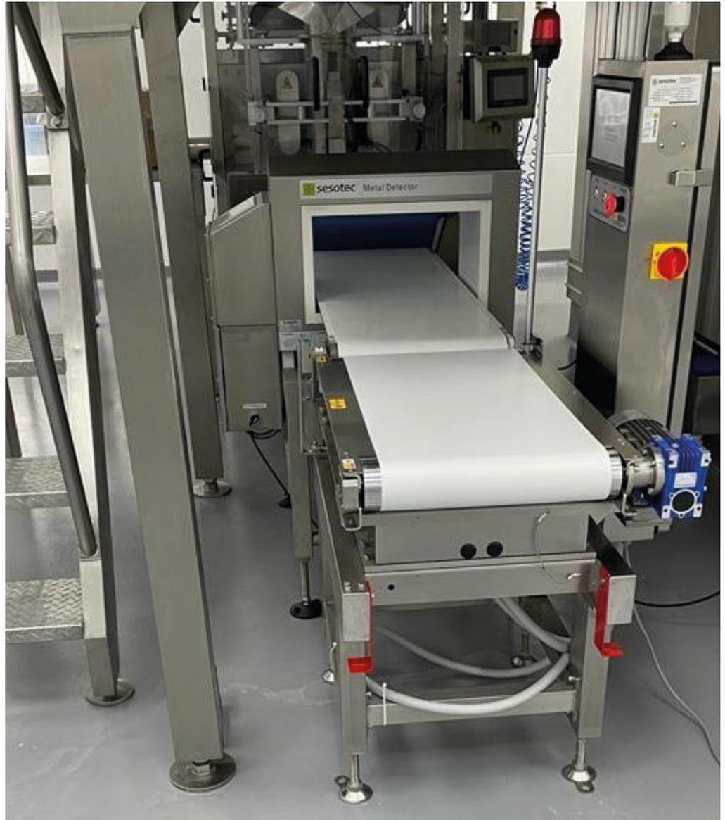
Metalldetektor GLS 450/250 GO DUO von Sesotec kann problemlos in eine bestehende Produktionslinie integriert werden.
