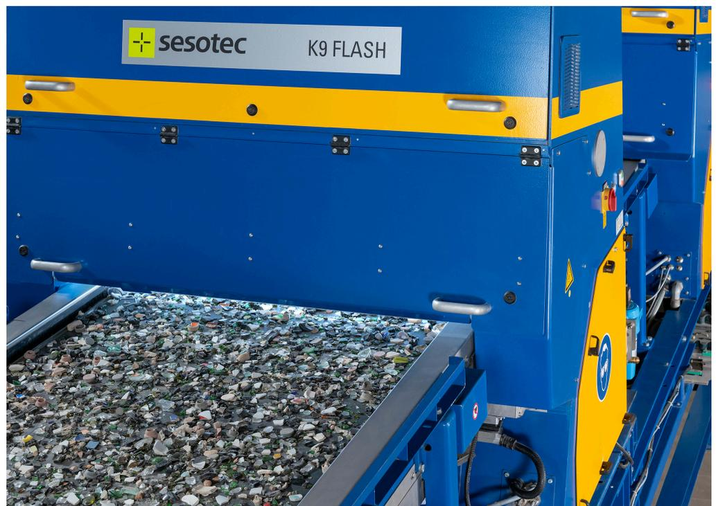
Laut Glassco ist die Anlage die „erste ihrer Art“ und verfügt über Hochgeschwindigkeitskameras und neueste LED-Lichttechnik zur Erkennung von Schwarzglas.
