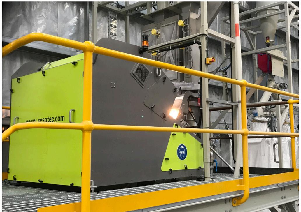
In Flight Plastics PET-Recyclinganlage wird Sesotecs Multi-Sensor-Sortiersystem FLAKE PURIFIER zur Feinsortierung der PET Flakes eingesetzt.
