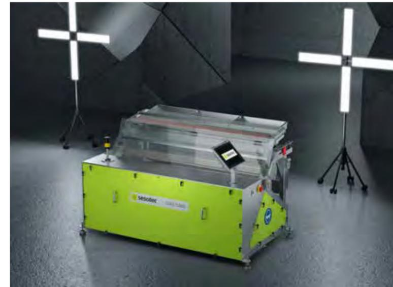
Anwendung zur Sortierung metallischer Verunreinigung im Kunststoff-Recycling
