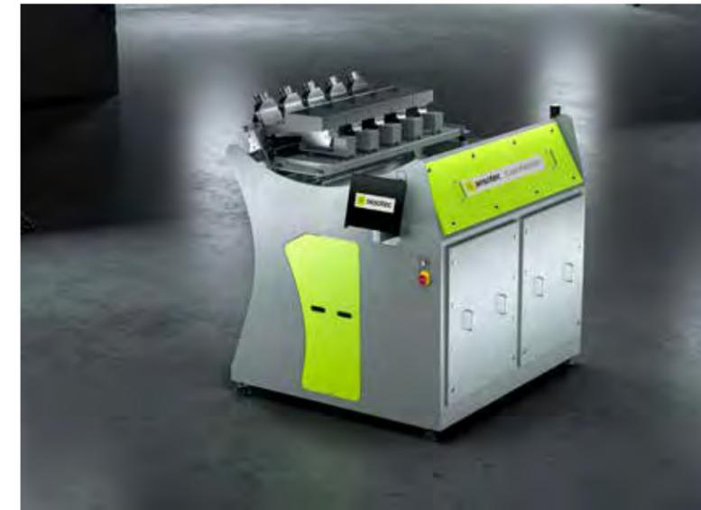
Anwendung zur Sortierung von Flakes und Mahlgütern im Kunststoff-Recycling
