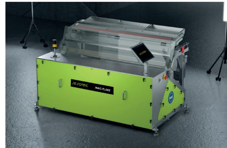
Anwendung zur Sortierung metallischer Verunreinigung im Kunststoff-Recycling
