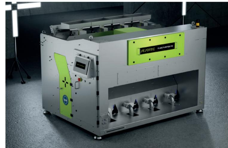
Anwendung zur Sortierung von Flakes und Mahlgut im Kunststoff-Recycling
