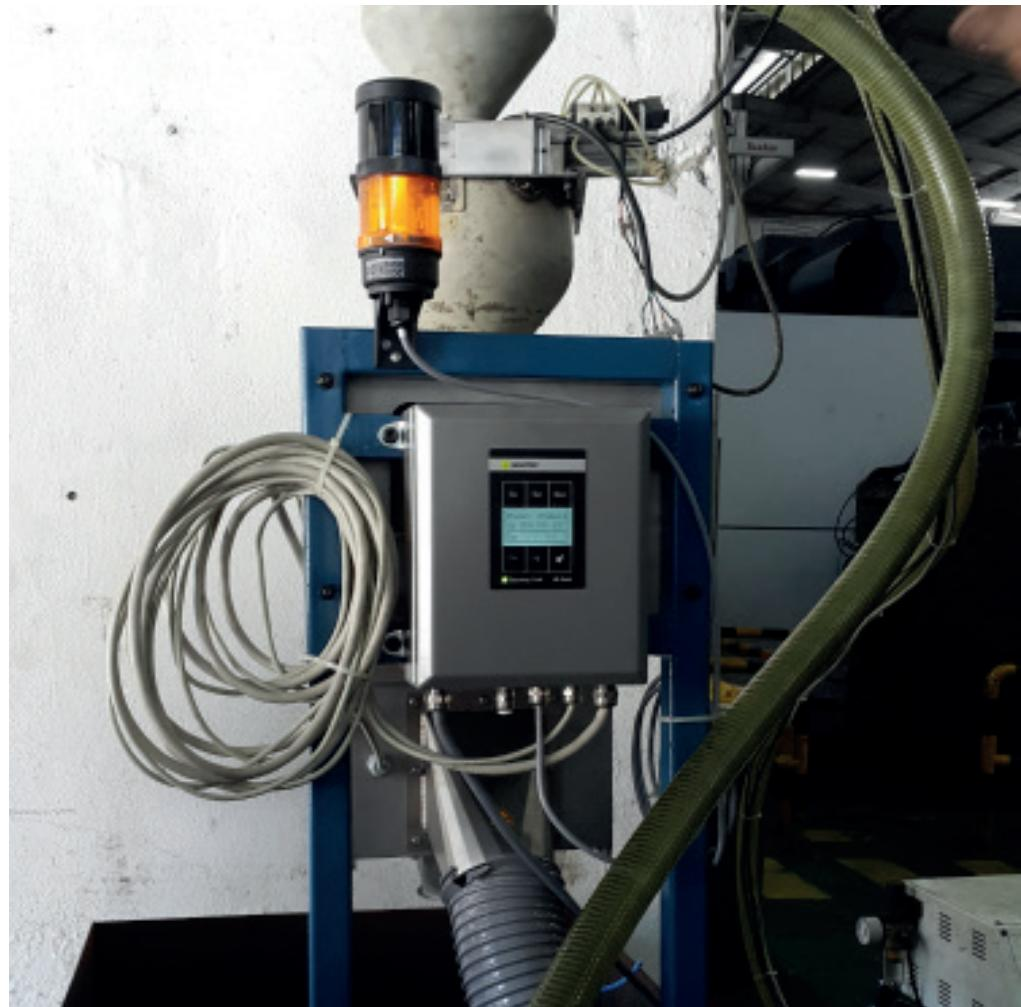
Während eines Besuchs nahm ein Techniker von JS Analytical einen RAPID VARIO-FS Metallseparator von Sesotec in Betrieb und demonstrierte in einer Live-Test-Vorführung, wie das Gerät ohne Unterbrechung der Produktion die Rohmaterialqualität von MSPI verbessern kann.
