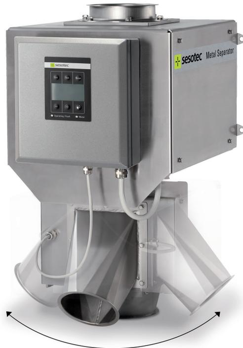
In dem für MSPI durchgeführten Test lieferte der RAPID VARIO-FS ein Ergebnis von 100% bei der Detektion und Ausscheidung von Metallteilchen, die den untersuchten Kunststoffrohmaterialien beigemischt waren.
