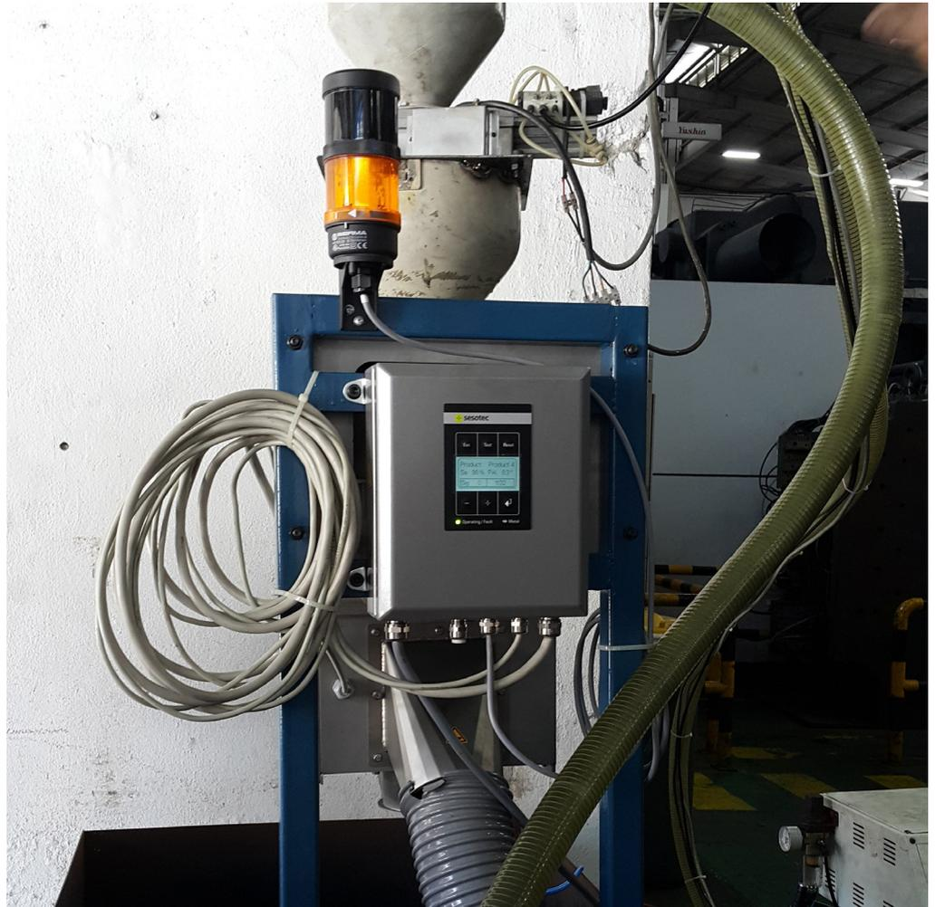
Während eines Besuchs nahm ein Techniker von JS Analytical einen RAPID VARIO-FS Metallseparator von Sesotec in Betrieb und demonstrierte in einer Live-Test-Vorführung, wie das Gerät ohne Unterbrechung der Produktion die Rohmaterialqualität von MSPI verbessern kann.
