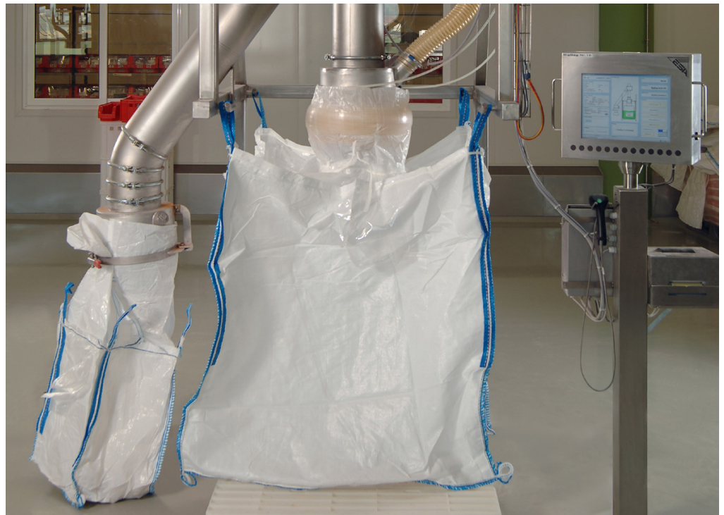
Bei „Almi“ erfolgt die IFS-konforme Metalldetektion unmittelbar vor Abfüllung der Gewürzprodukte in Bigbags.
